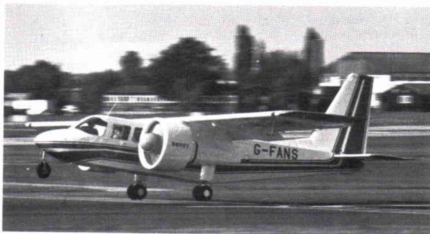
"Gräsklipparen" ISLANDER med inbyggda propellrar. Ljudstyrka på 100 m avstånd bara 60 dB (A).
