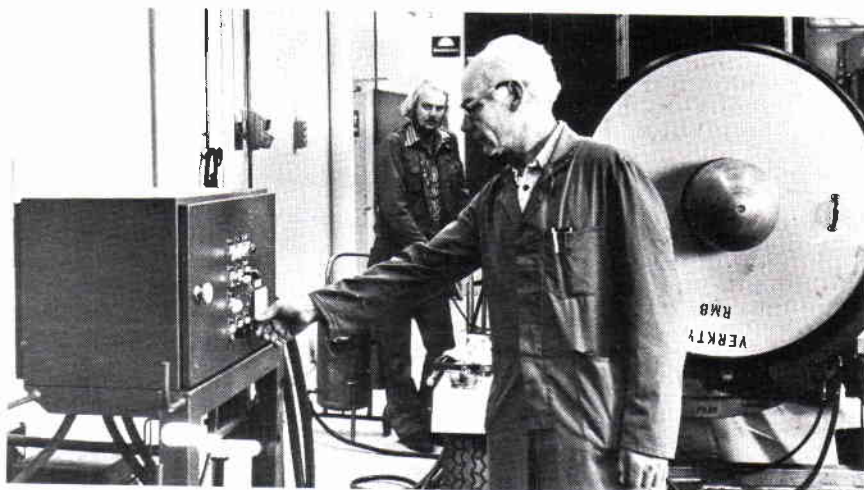
Fvm Torbjörn Blom t v passar oljetrycket, medan vm Stig Nilsson manövrerar konserveringsaggregatet för RM 8 i F 15 flottiljverkstad.
